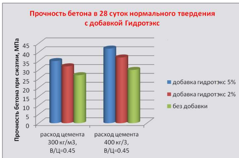
Рис.2. Прочность бетона в зависимости от расхода цемента и количества введенной добавки
